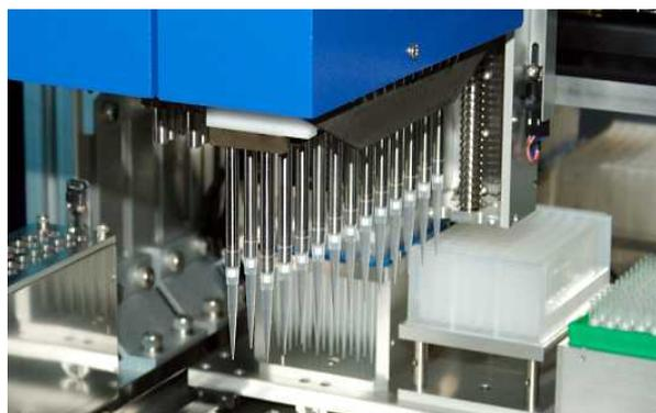
隣同士のウェルピッチが異なる複数の容器に対応したノズルピッチ可変式分注ヘッド
